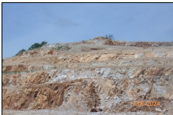
รูปที่ 2-11 การเปิดหน้าเหมืองลักษณะชั้นบันได
