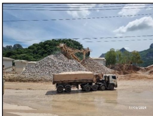
รูปที่ 2-21 การปิดปกคลุมท้ายกระบะบรรทุก
