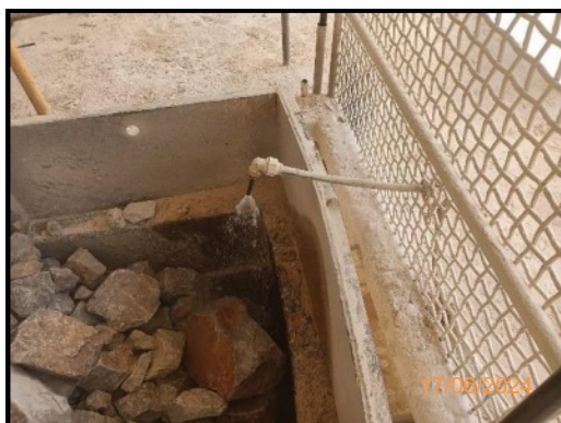
รูปที่ 2-18 ระบบสเปรย์น้ำที่จุดกำเนิดฝุ่น
